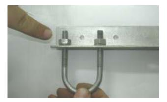
Anclaje de sensor de radiación solar. Se sujeta en la base de apoyo y tornilleria de sujeción que acompaña al sensor.
