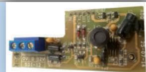
**AS 170** Protector de descargas eléctricas unipolar para entradas analógicas y digitales.
