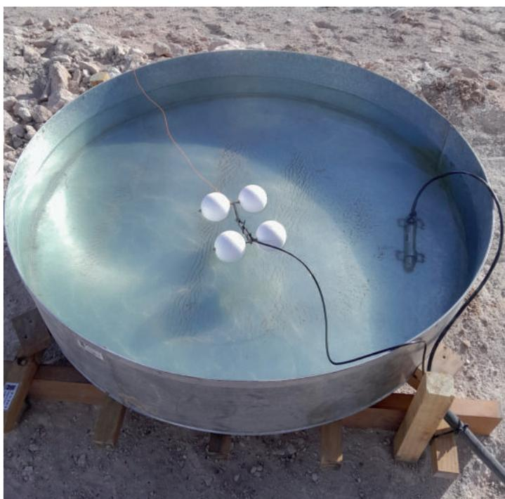
Tanque de evaporación con base de madera TS261 -
