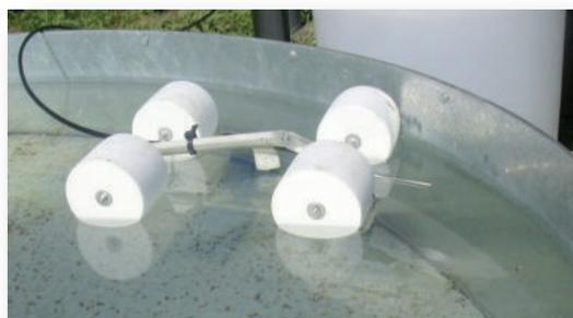
Sensor TS 265 con flotador para tanque de evaporación
