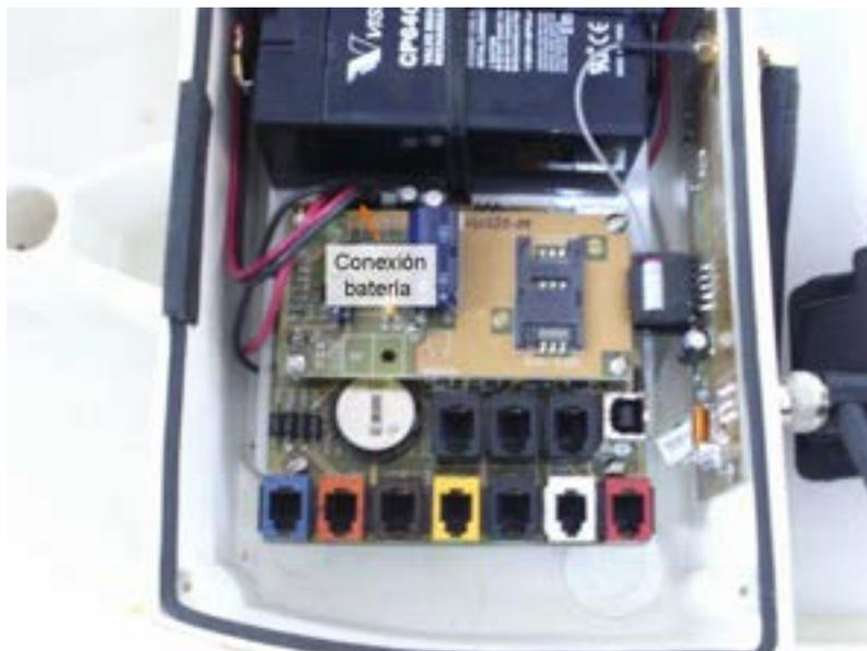
La batería se encuentra desconectada para preservar la carga al momento de poner en marcha el equipo. Una vez conectado el/los sensor/es, proceda a conectar la batería.
