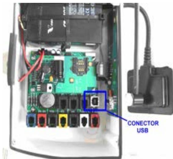
**Importante:** es necesario que la Unidad de Adquisición y la PC en la cual se ejecuta la aplicación, se encuentren conectadas a través del cable USB previamente a la ejecución del *software EP2010*.
