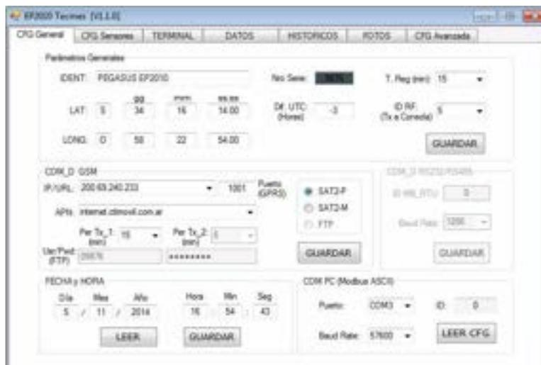
En la esquina inferior derecha, dentro del recuadro COM PC, debe seleccionar el puerto, el baud rate por defecto es 57600. El programa al abrirse carga un valor de puerto por defecto, e intenta establecer una comunicación con el EP2010 y leer su configuración y datos instantáneos. Si observa el siguiente cartel
