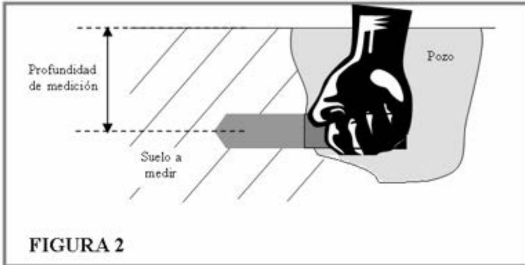
Luego de instalado, ingrese a la Pantalla DATOS del Software y verifique que la indicación se encuentre entre 0 y 100% de acuerdo al estado del terreno, cuanto mas húmedo, mayor la indicación.
