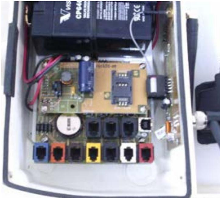
En el circuito electrónico, los conectores RJ11 poseen el color que los identifica para conectarlos correctamente con sus correspondientes sensores.
