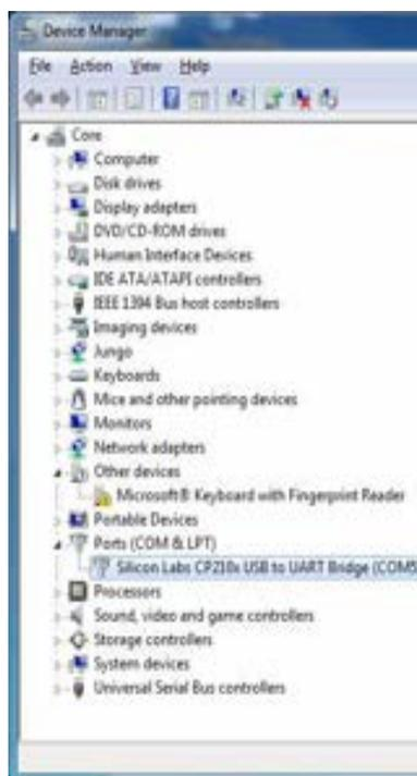
Si el equipo no aparece en la lista, o aparece en “Otros dispositivos” con un signo de admiración, como en la imagen siguiente, el controlador no se ha instalado correctamente (contactar a servicio técnico por mayor asistencia)
