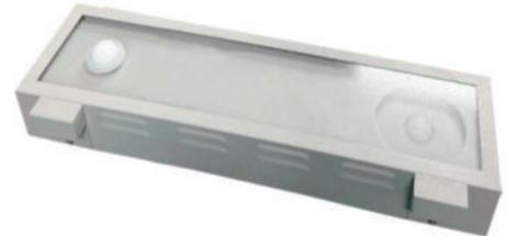
El sensor de suciedad de módulo TS 305 para centrales fotovoltaicas se instala fácilmente en un nuevo sistema fotovoltaico existente se integra en el sistema de gestión de la central. El dispositivo se monta en el marco de los paneles fotovoltaicos. Mediante la medición continua de las pérdidas de transmisión causadas por el polvo en el vidrio, se calculó la reducción en la cantidad de luz solar que llega al panel solar.
