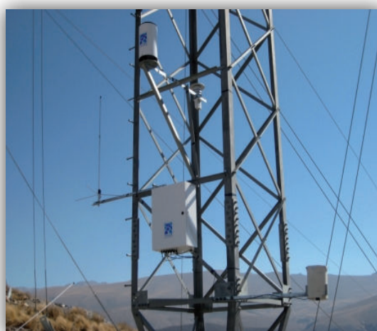
Medición de altura de nieve y parámetros meteorológicos, Minera Alumbraera, Catamarca, Argentina
