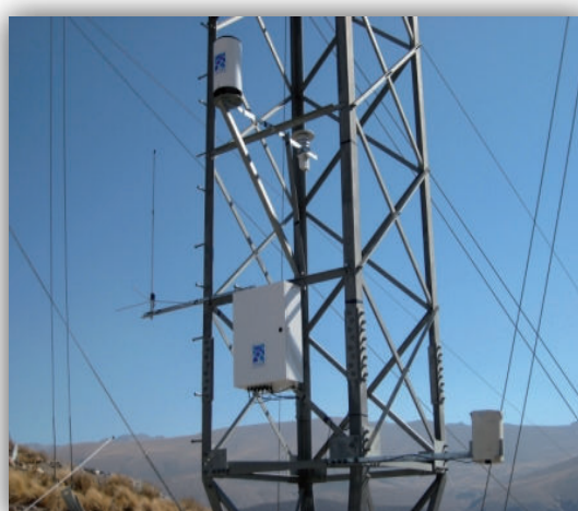
Medição da altura da neve e parâmetros meteorológicos, Minera Alumbrera, Catamarca, Argentina
